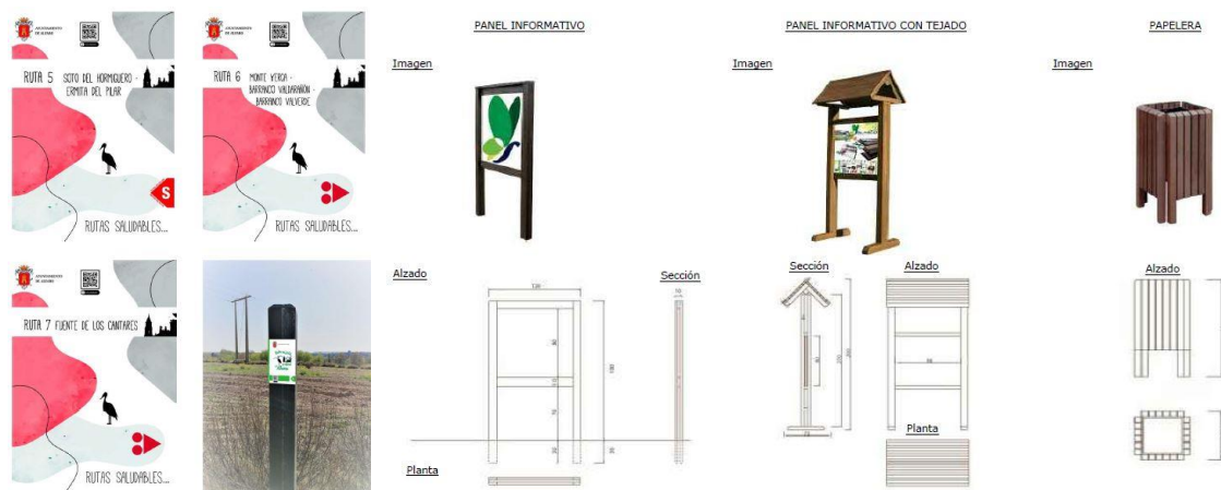
Fig.5.13. Detalle de señalización, paneles y mobiliario.
